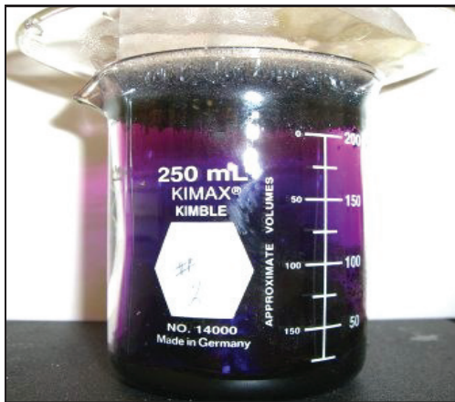
Şekil 2.26. Oda sıcaklığında iyot gri renkli katı maddedir. Soğuk bir cisimle temas halinde katı hale dönüşen mor buharla süblimleşir. İyotun bu özelliği, onu karışımlardan ayırmak için uygulanabilir.
