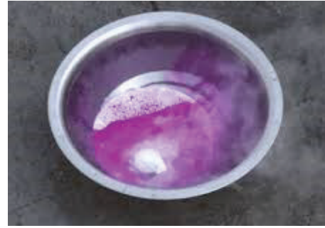
Şekil 5.3. Sodyum su ile reaksiyona girerek sodyum hidroksit elde edilir. Sodyum hidroksitin sulu çözeltisine birkaç damla fenolftalein göstergesi eklenirse, çözelti mor rengini alır.
