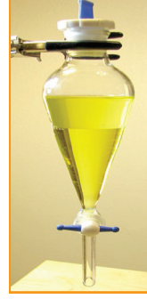
Şekil 2.27. Ayırma hunisi. Alt kapağı açarak alttaki sıvı bir toplama kabına akabilir.
