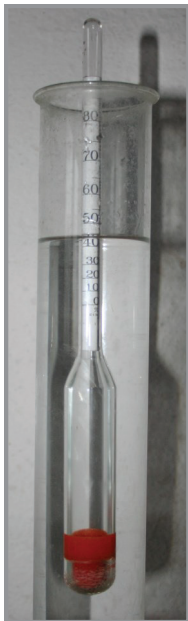
Şekil 2.3. Sıvıların yoğunluğu areometre (hidrometre) adı verilen aletle ölçülür.
