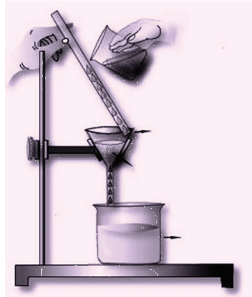
Şekil 2.28. Filtreleme ekipmanı. Filtre kağıdından berrak sıvı geçer, filtre kağıdında ise katı madde kalır.
