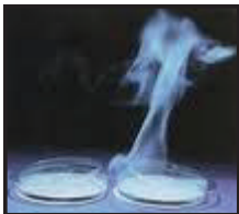
Şekil 5.8. Biri konsantre HCl ve diğeri konsantre NH 3 çözeltisi içeren iki kap yan yana getirilirse, onların buharları (gaz halinde HCl ve NH 3 'ten oluşan) aralarında bağlanarak amonyum klorür, NH 4 Cl oluşur.
