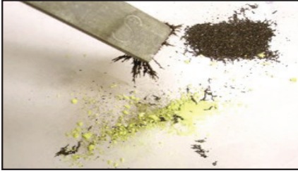
Şekil 2.25. Demir, manyetik özelliklerine dayanarak karışımdan ayrılabilir.
